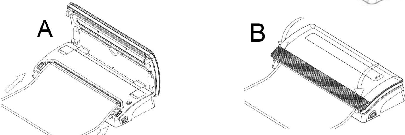
4. Chiudere il coperchio e premerlo su entrambi i lati con le mani verso il basso (Figura B), fino a quando sentite che l'apparecchio mette sotto vuoto il sacchetto (LED 9) e poi lo salda (LED 10). L'apparecchio si arresta automaticamente.
