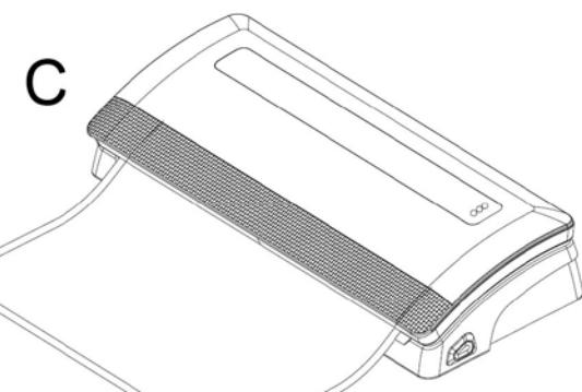
4. Sluit het deksel en druk het met uw handen aan beide kanten stevig naar beneden, totdat u hoort dat de motor van het apparaat werkt, en druk het deksel vervolgens enige seconden naar beneden (afbeelding C). Het apparaat trekt het deksel vast en last het zakje dicht. Het apparaat stopt automatisch, wanneer het zakje is dichtgelast.
