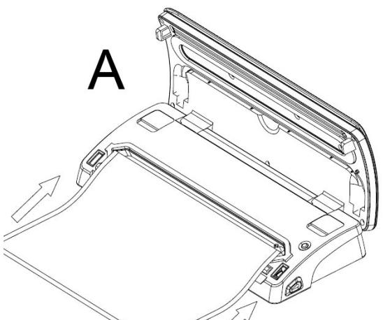
3. Coloque la bolsa como se muestra en la ilustración (A) en la cámara de vacío (5). La bolsa no debe colocarse sobre la tubuladura de aspiración (3), ya que de lo contrario no podría generarse
