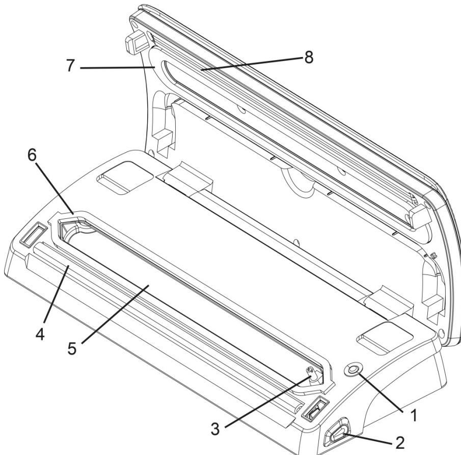
**1 Interrupteur de sécurité:** s'enclenche quand le couvercle est fermé.
