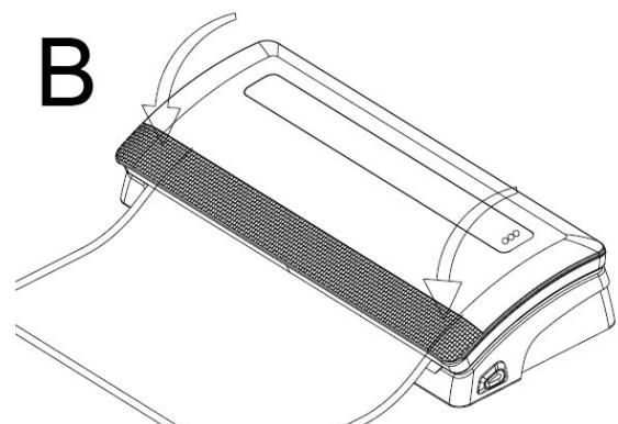
6. Contrôlez le sac mis sous vide ; il devrait présenter une soudure à l'emplacement du scellage et n'avoir pas de plis. Si ce n'est pas le cas, l'emballage n'est pas hermétique.
