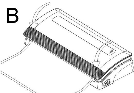
4. Schließen Sie den Deckel und drücken Sie ihn auf beiden Seiten mit den Händen fest nach unten (Abbildung B), bis Sie hören, dass das Gerät den Beutel vakuumiert (LED 9) und dann verschweißt (LED 10). Das Gerät stoppt automatisch.
