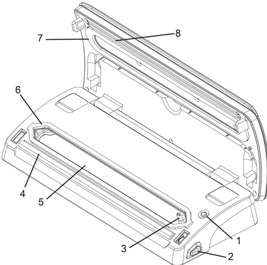
**1 Sicherheits-Schalter:** Wird bei geschlossenem Deckel ausgelöst.
